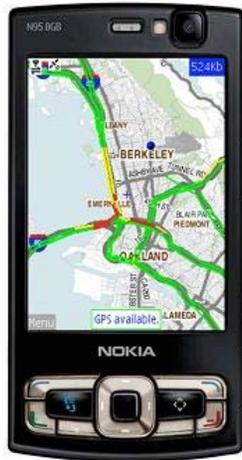
Il s'agit d'obtenir des **données en temps réel** sur le trafic automobile en collectant la position des mobiles Nokia dotés d'un récepteur GPS afin de déterminer les zones de ralentissement et de proposer des itinéraires alternatifs.
